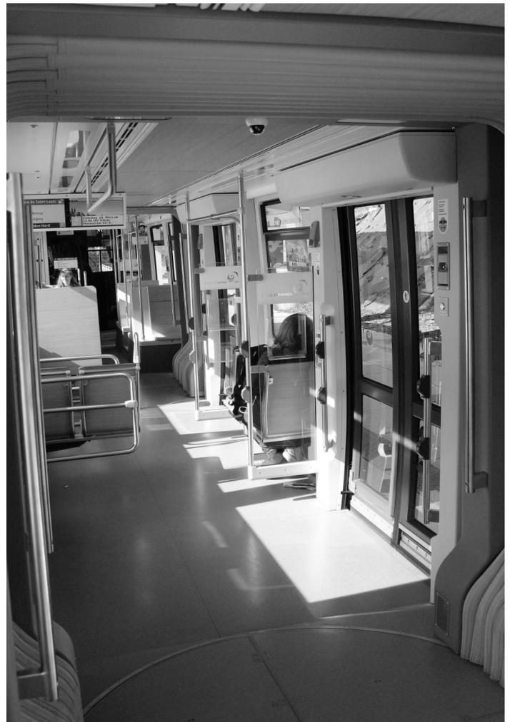
**Bilder oben:** Innenraum des «Flexity Basel»; Fahrgastanzeige, Anordnung der Sitzplätze, Eingangspartien mit Abstellfläche für Kinderwagen, Rollstühle etc. Aufnahmen 24.03.2018; Hans Bodmer, Gossau ZH
